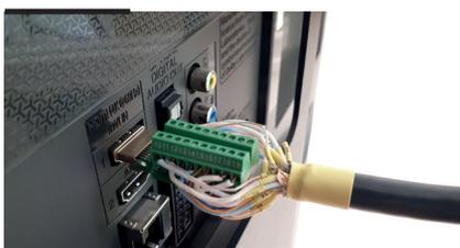
Schließen Sie den HDMI-Stecker an ein Display an (Fernsehbildschirm oder Videoprojektor) und stellen Sie sicher, dass das Kabel funktionstüchtig ist. Falls kein Bild erscheint, korrigieren Sie die Verbindungen wie in Schritt **4 und 5** beschrieben.
