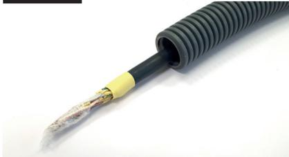
Ziehen Sie mithilfe einer Einziehnadel (nicht im Lieferumfang enthalten) das HDMI-Kabel mit den 20 nummerierten Drähten durch den PVC-Mantel (Innendurchmesser mindestens 14mm).
